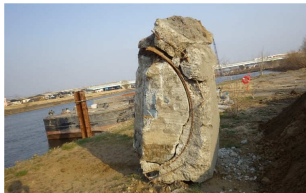
完全に充填され、材料分離や空隙は見られない
