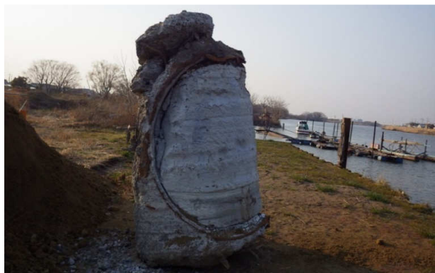
完全に充填され、材料分離や空隙は見られない
