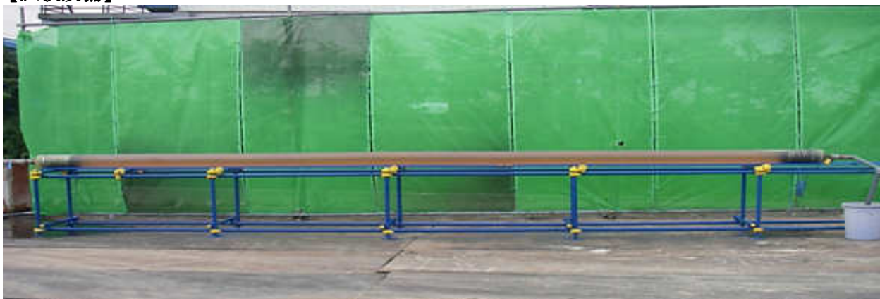
充填管模型 \phi 200 L=8.00m 水を満たした透明管(赤色着色)
