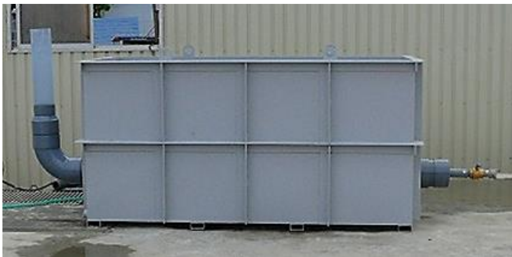
外側容器・有孔管模型注入口及び吐出口取付状況
