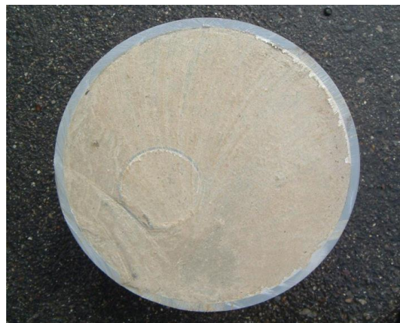
充填試験 注入管切断面
