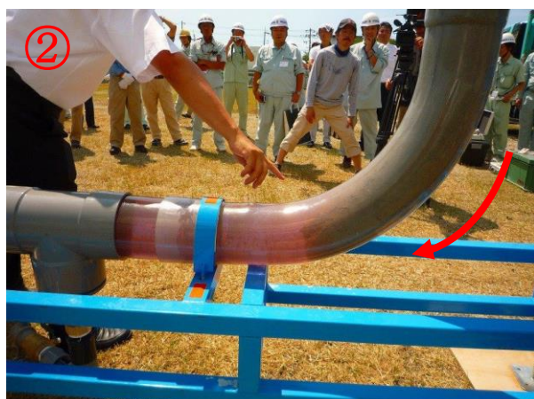
滞留水とセルクリートモルタルの断面
