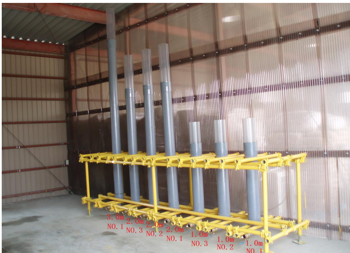
打設面変位測定装置
