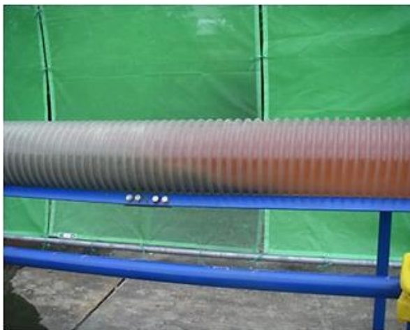
充填材の滞留水との境界面 （滞留水との接触面は乱されておらず、充填材が残留水を押し出している）
