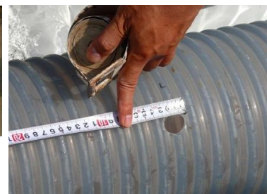
外側容器・有孔管模型注入口及び吐出口取付状況
