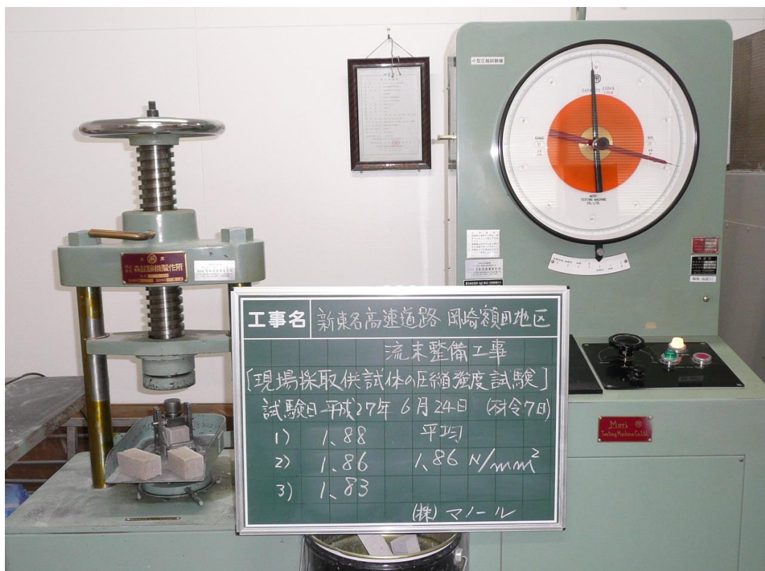
参考写真 小型強度試験機による圧縮強度試験
