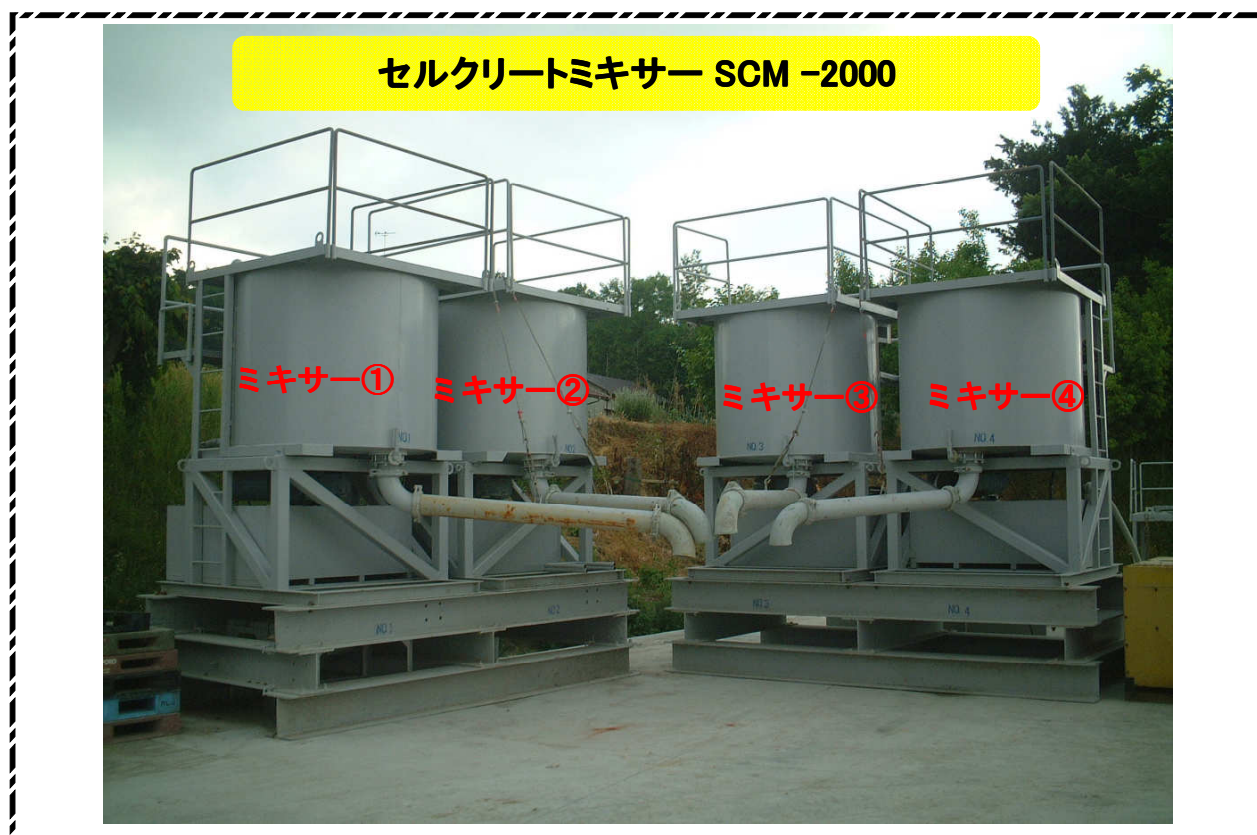
定置式プラント（2組設置）
