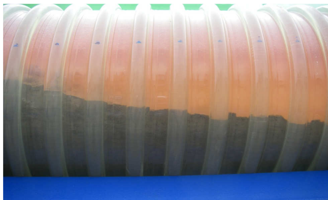
材料分離が無く、セメント等で水を汚してない。 水を汚さないで汚水処理の問題が無い。
