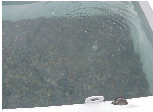
注入初期段階：注入に伴う管内気泡の排出
