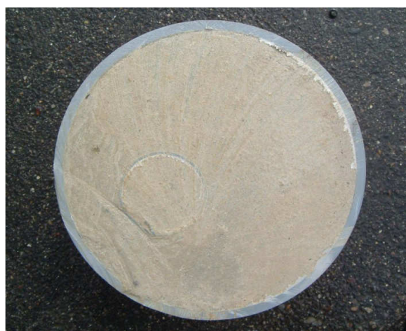
充填試験 注入管切断面
