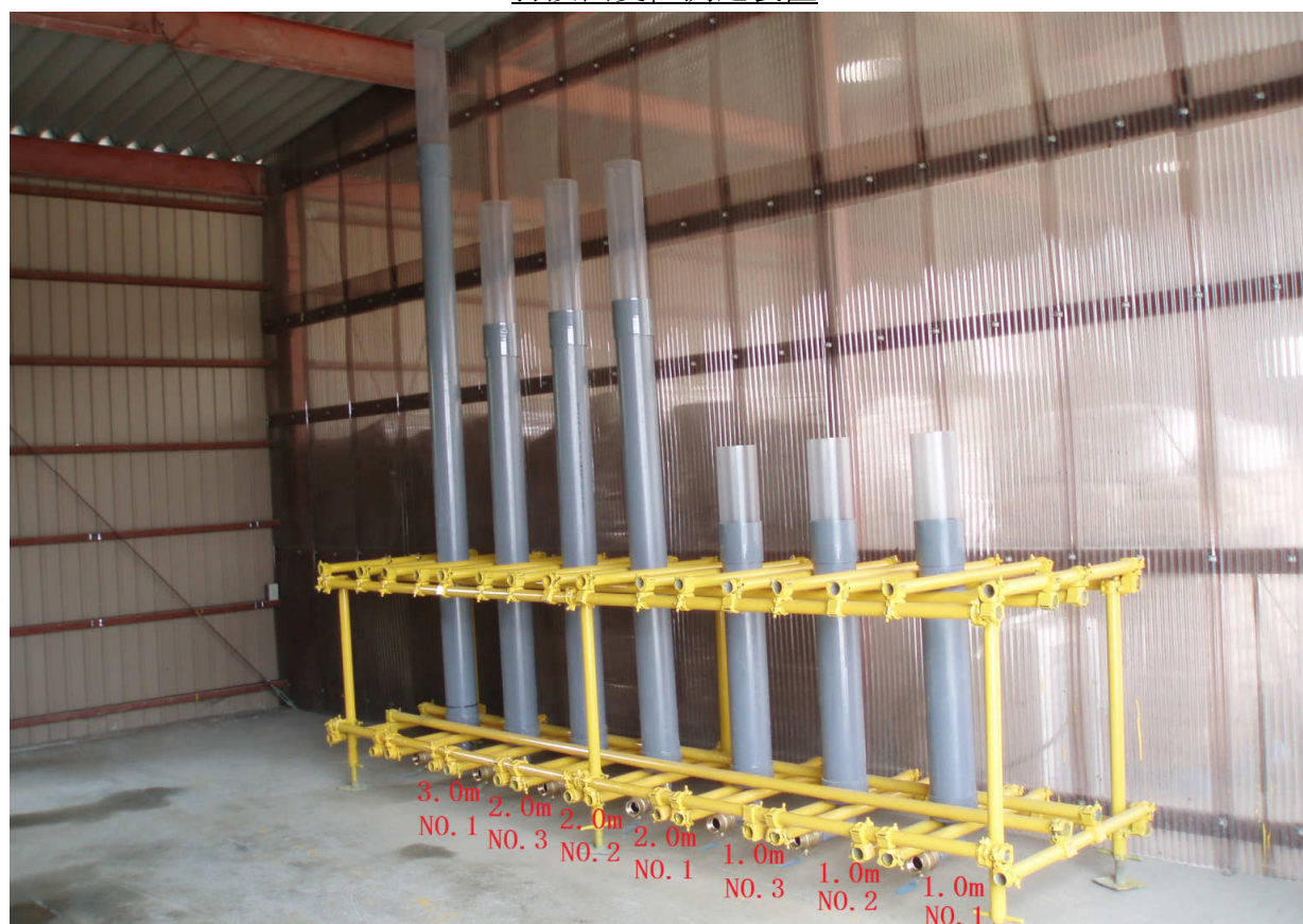
打設面変位測定装置
