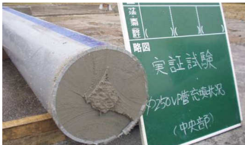
セルクリート工法による管内充填状況 実証試験施工による確認
