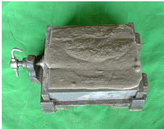
参考写真 一軸圧縮強度試験供試体の採取
