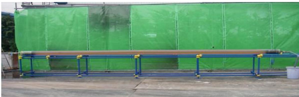
充填管模型 φ200 L=8.00m 水を満たした透明管(赤色着色)
