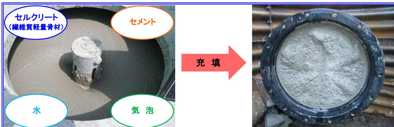
『セルクリート工法』の注入材料は、繊維質混和材と独立気泡との相乗効果による次のような特性があります。
