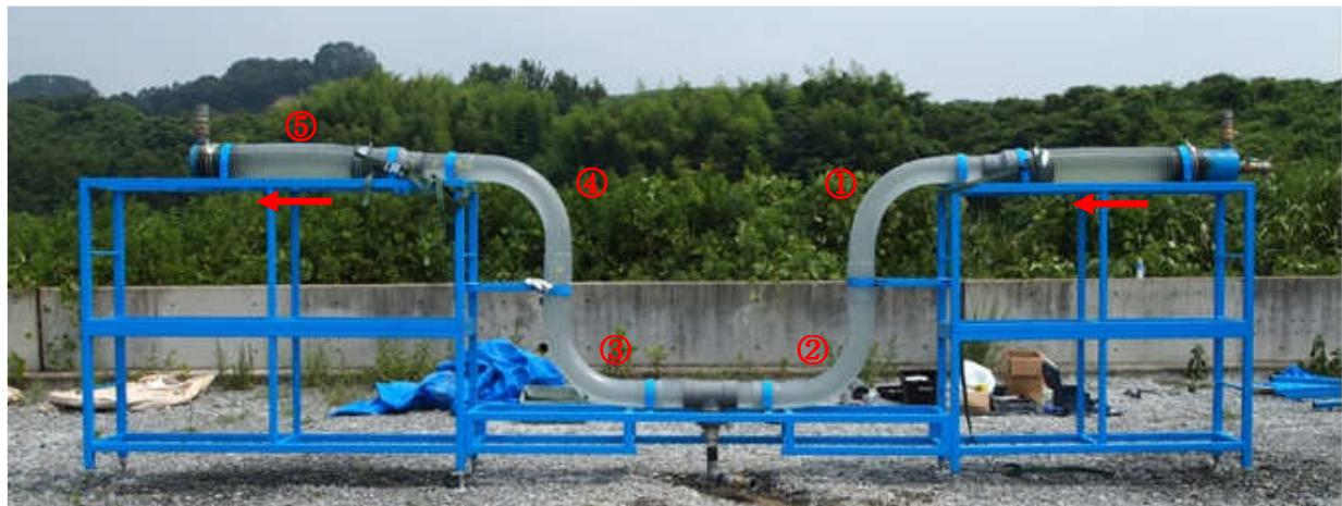
注入開始後、下り勾配になったセルクリートモルタルは滞留水と接した断面に濁水の発生や材料分離が確認されず滞留水を押し出す様子が確認できた。
