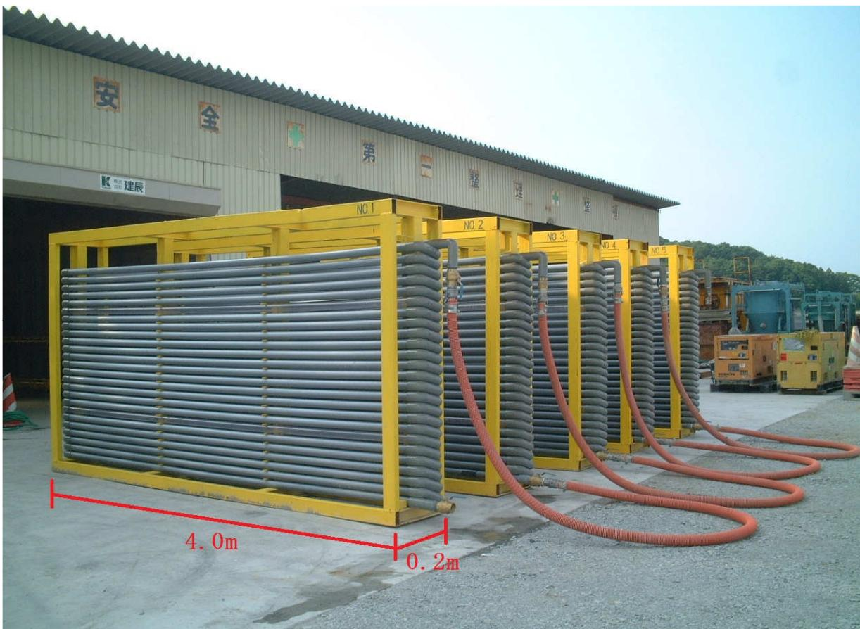
〈試験装置〉 注入管 = VP  $\phi 50\text{mm}$  L = 1,050m
