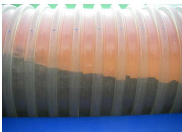
充填先端部の水との接触面は、セルクリートモルタルの比重が水より重いため水の下に入り込む形態となっている。
