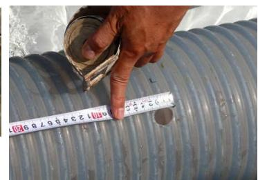
本実験により、有孔管に注入された充填材料は孔部より流出せず、管内充填が可能であることを目視確認することが出来た。
