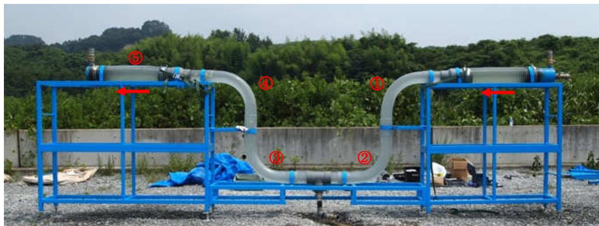
注入開始後、下り勾配になったセルクリートは滞留水と接した断面に渦水の発生や材料分離が確認されず滞留水を押し出す様子が確認できた。
