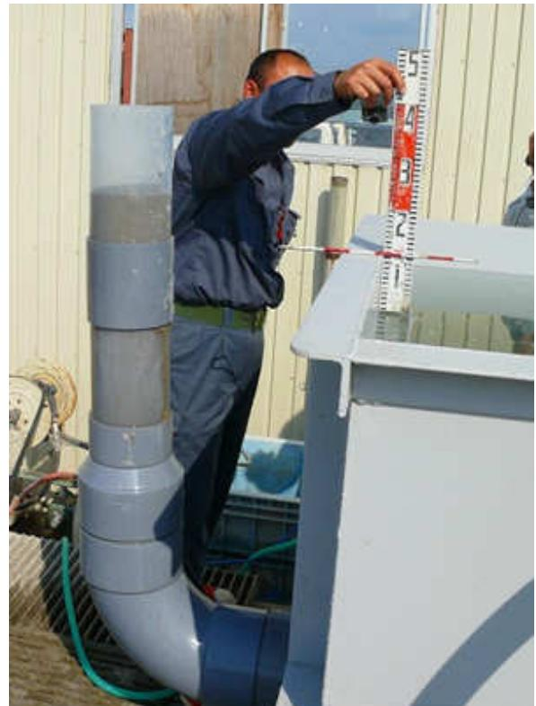
水槽水面上部への充填材の押上げ
