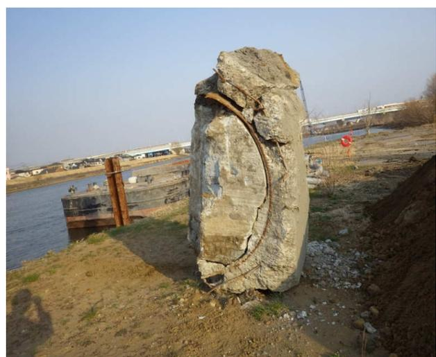
完全に充填され材料分離や空隙は見られない
