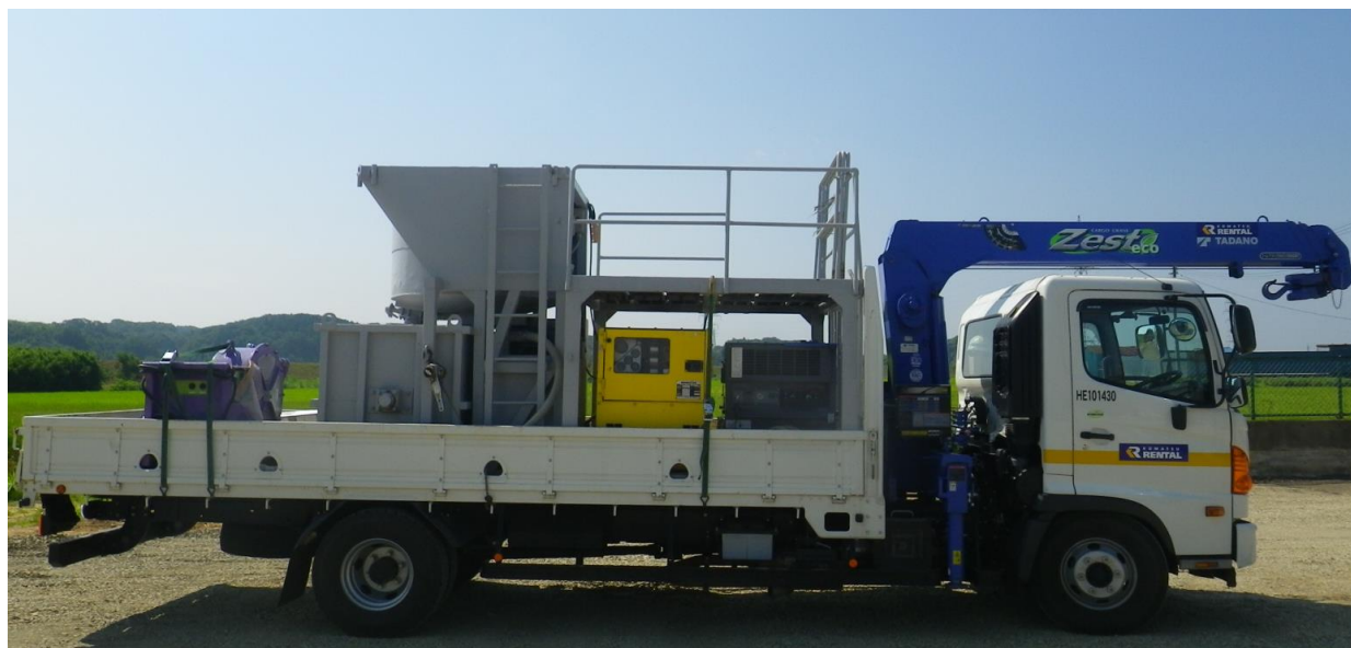
4t クレーン装置付きトラック搭載状況
