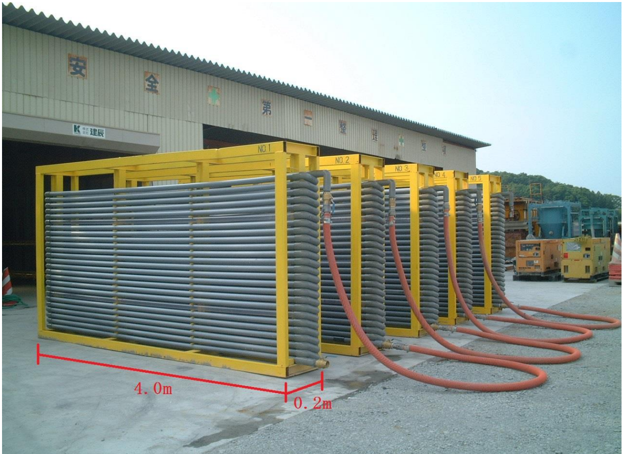
長距離圧送実験 試験装置
