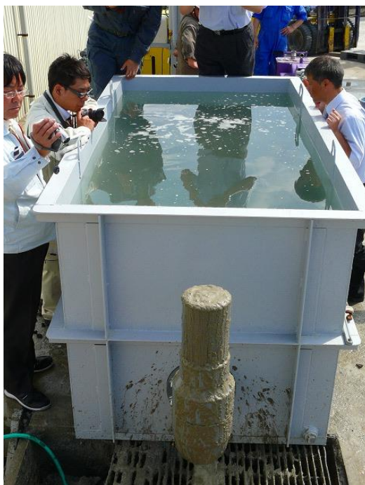
管内充填完了時の状況 吐出管からの充填材流出を確認水槽内は清水状態を保つ
