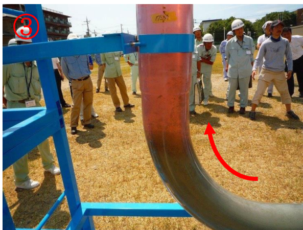
③ 屈曲部の充填確認（上方向）
