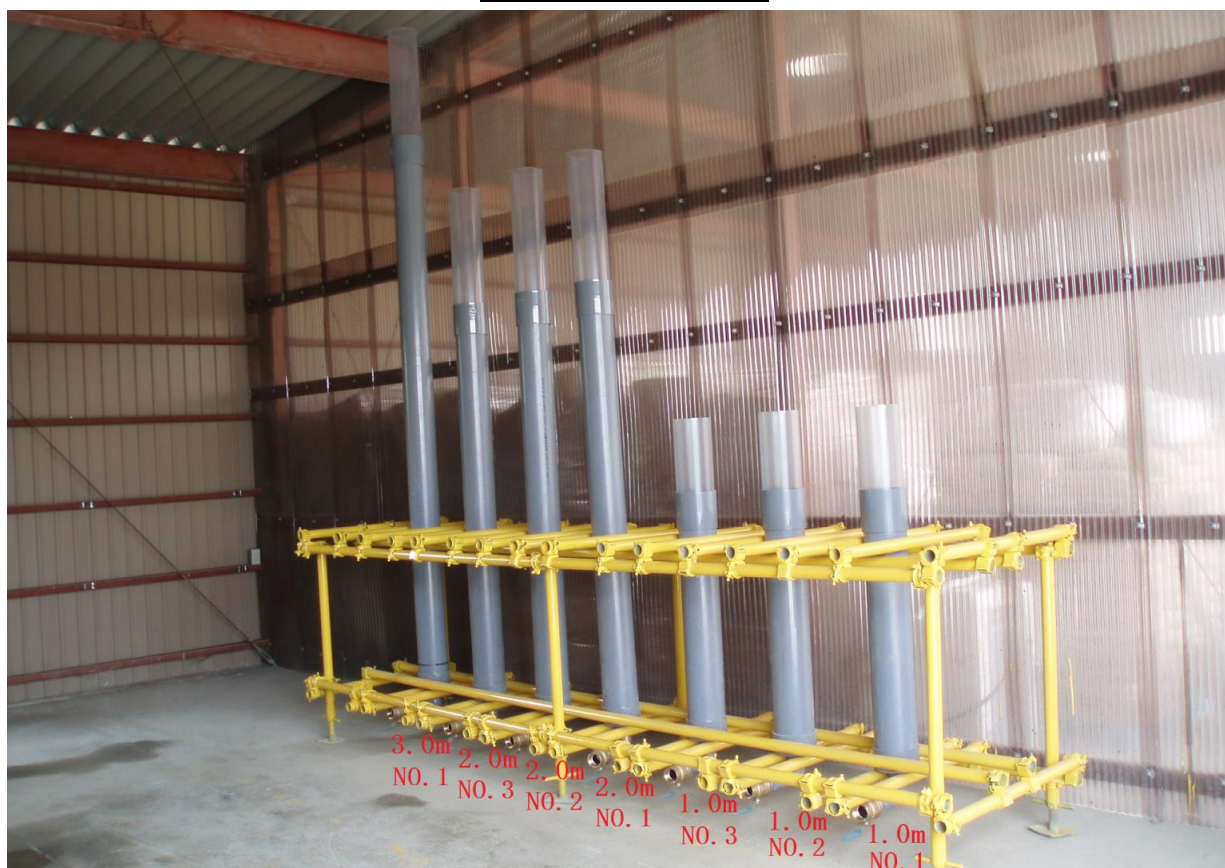
打設面変位測定装置
