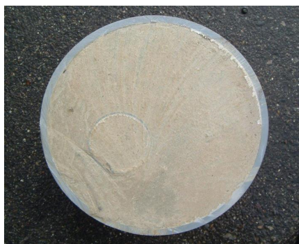
充填試験 注入管切断面
