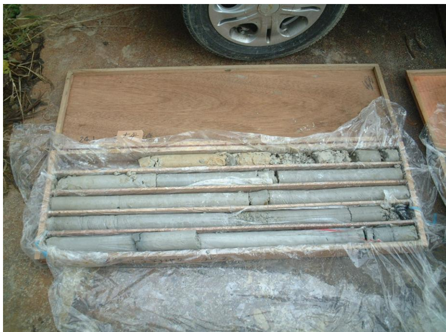
材料分離や空隙が無い事を確認
