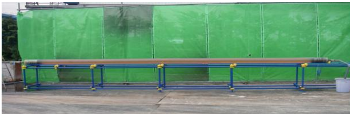
充填管模型 φ200 L=8.00m 水を満たした透明管(赤色着色)
